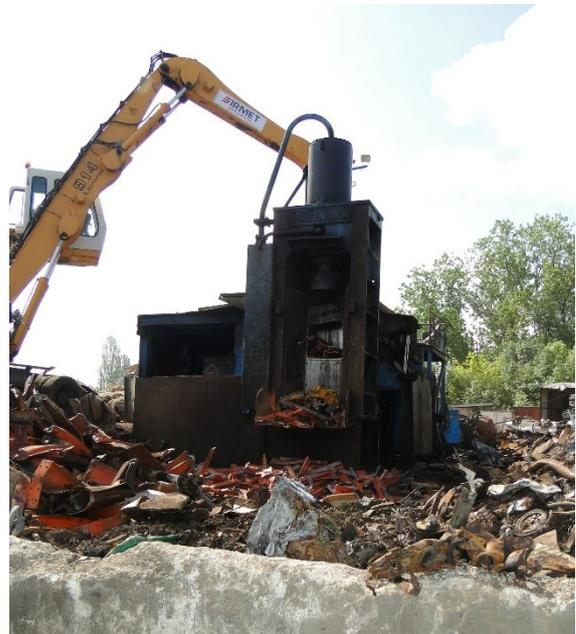
FIGURE 15 : PRESSE CISAILLE - SITE GOND PONTouvre
