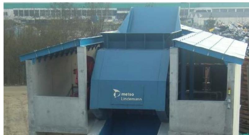
FIGURE 18 : PRE-BROYEUR SITE GOND PANTOUVRE
