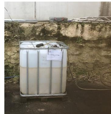
FIGURE 8 : CUVE GRV AVEC EAUX DECONTAMINATION FILTREE A 5  $\mu\text{M}$
