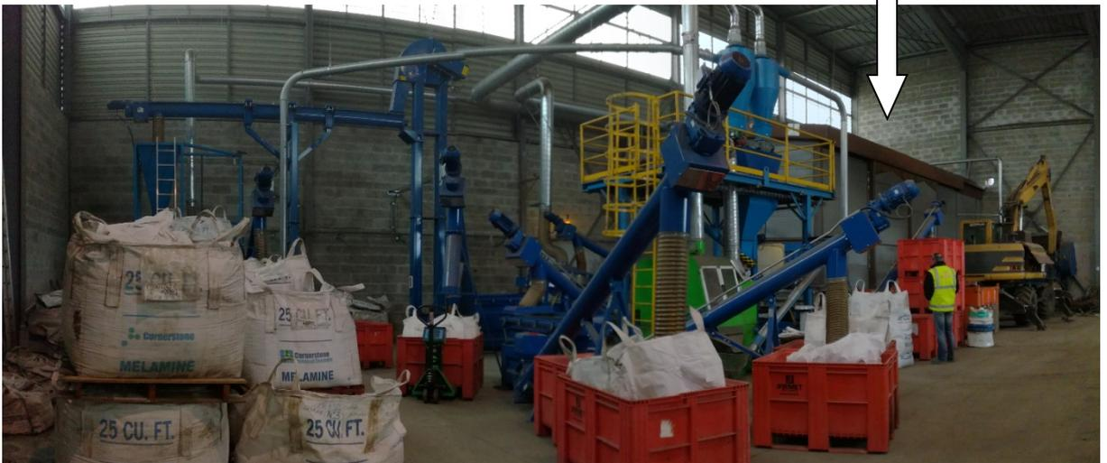
FIGURE 24 : ILLUSTRATION DE LA LIGNE DE BROYAGE DES CABLES
