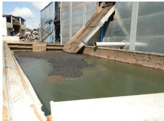
FIGURE 22 : BENNE DE COLLECTE DES BOUES ISSUES DU DEPOUSSIÉREUR
